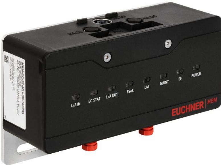
Das Busmodul für Ethercat P ist Gateway für bis zu 4 Zuhalte- oder Erweiterungsmodulen (Bild: Euchner).
