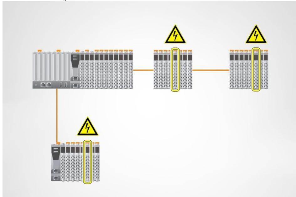
Durch Anzeige des Leistungsbedarfs von IO-Modulen wird die Inbetriebnahme schneller und vorhersehbarer (Bild: B&R).
