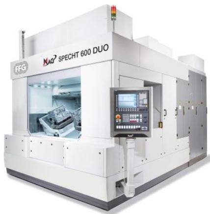
20 der horizontalen 5-Achs-Bearbeitungszentren bearbeiten Gehäuse und Lagerschilde für den elektrischen Antriebsstrang (Bild: MAG IAS).
