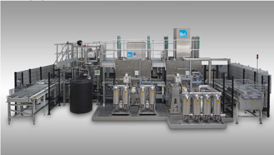
In dieser Reinigungsanlage werden Pumpenkomponenten in einem System bei hoher Taktzeit gereinigt und getrocknet (Bild: BvL).
