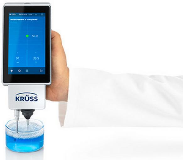
»BPT Mobile« für die Qualitätskontrolle reinigungs- oder netzmittelhaltiger Bäder. Bild: Krüss
