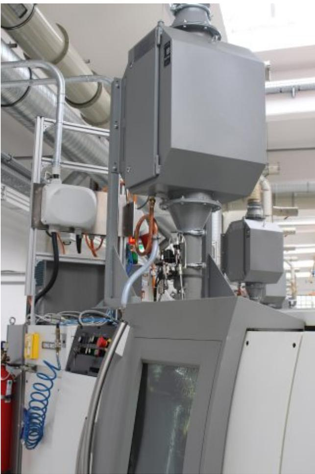
Die Flammensperre von Büchel verhindert zuverlässig, dass sich ein Maschinenbrand über die Absauganlage auf die gesamte Fertigung ausbreitet (Bild: Böllhoff).
