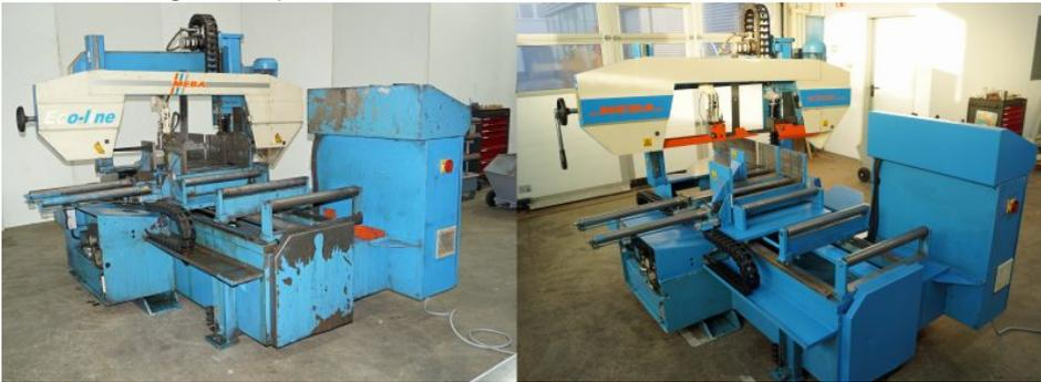
Links die Doppelgehrungssäge vor dem Retrofit, rechts der Zustand nach der Überholung (Bild: Meba).
