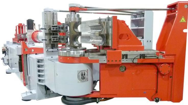
Die Rohrbiegemaschine hält der hohen Beanspruchung beim 1xD-Biegen auch bei langer Einsatzdauer stand (Bild: Schwarze-Robitec).
