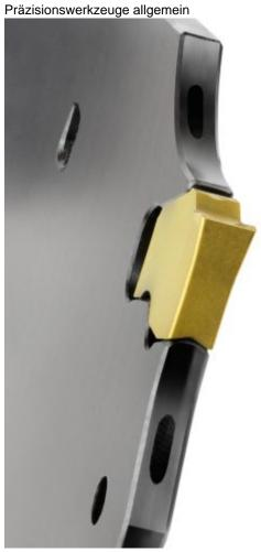
Additive Fertigung erlaubt die Herstellung von Zerspanungswerkzeugen mit optimierter Kühlmittelzufuhr (Bild: Ingersoll).
