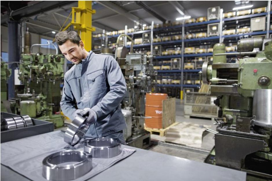
Die saugstarke Ölauffangmatte im Mietmodell wiegt lediglich 600 g und nimmt bis zu 3 l Flüssigkeit auf (Bild: Mewa).
