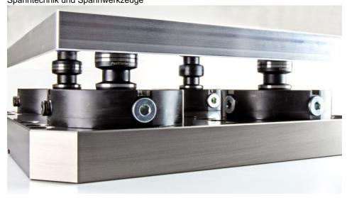
Das Nullpunktspannsystem ist robust gebaut, einfach in der Handhabung und sicher in der Anwendung (Bild: Tschorn).
