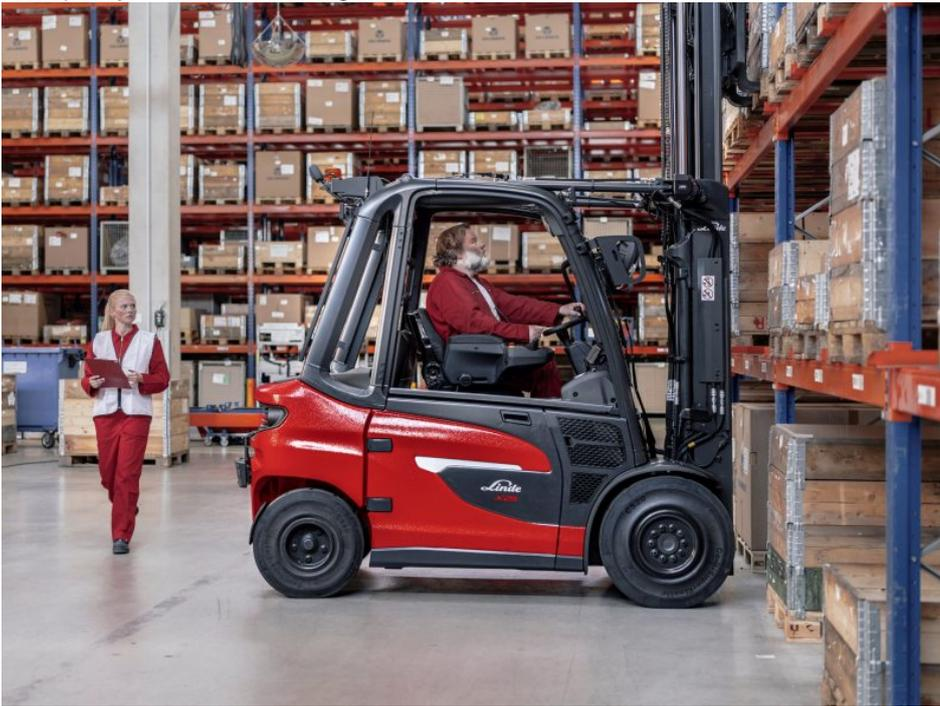
Das Assistenzsystem sorgt für einen besseren Schutz, indem es Bewegungen hinter einem stehenden Stapler erkennt (Bild: Linde).
