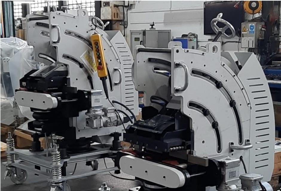
Die mobile Schweißkantenfräse kann für Bleche zwischen 3 und 50 mm Dicke eingesetzt werden (Bild: Cevisa).
