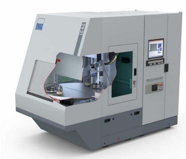
Laserreinigung entfernt rückstandsfrei und effizient Öle, Oxide, Lacke oder technische Beschichtungen (Bild: Emag LaserTec).
