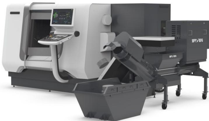
Die neue hydraulische Spänepresse kann direkt unter den Späneförderer platziert werden (Bild: Weima).
