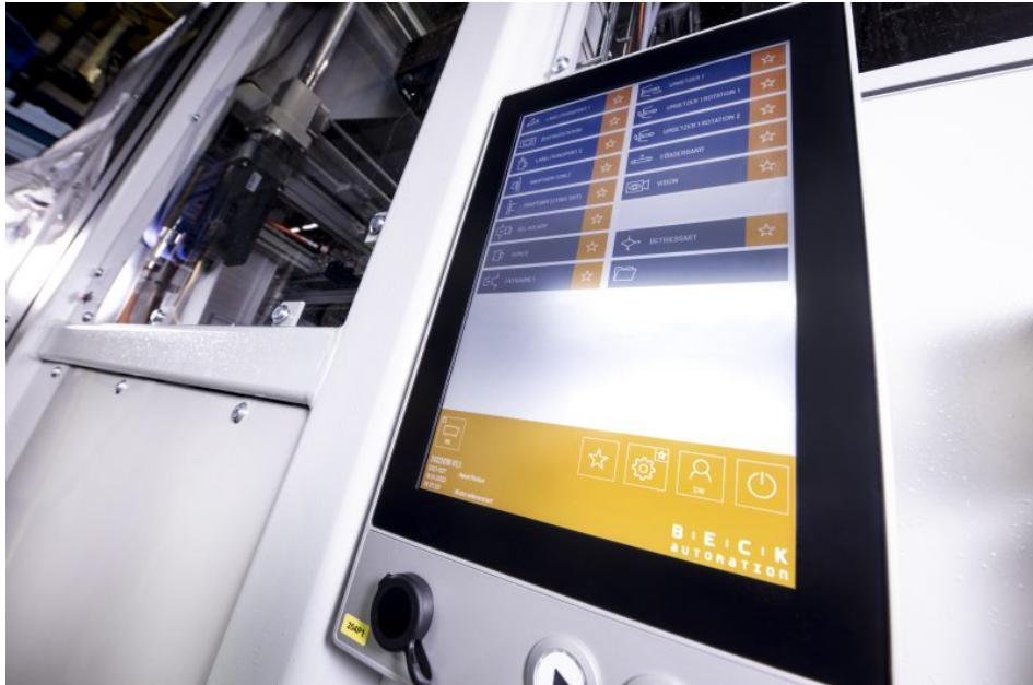
Das moderne HMI-System im Hochformat integriert separate Taster für den direkten Funktionszugriff (Bild: Beck Automation).
