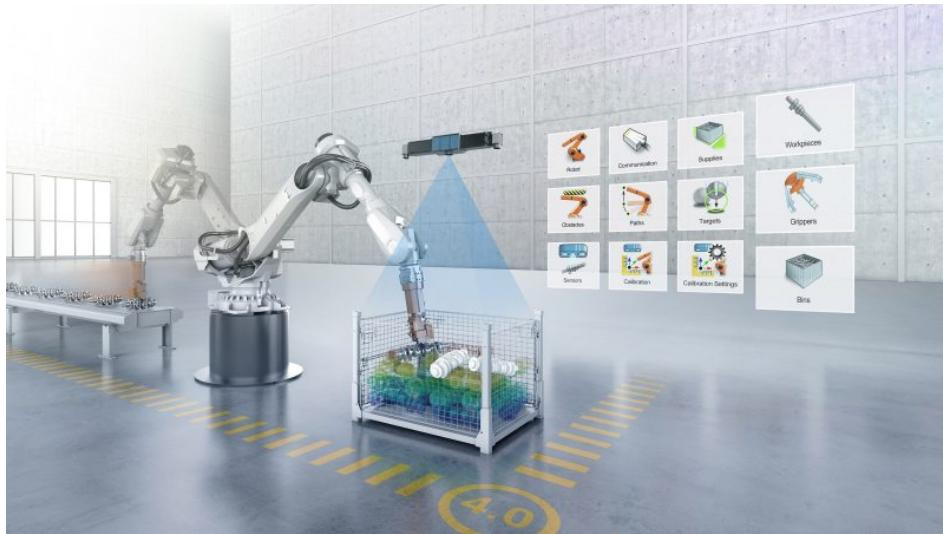
Die Bin-Picking-Lösung umfasst neben der grafisch geführten Software auch ein projektorbasiertes 3D-Kamerasystem (Bild: Liebherr).
