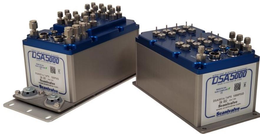
Der 16-kanalige Druckscanner nutzt pro Messkanal je einen Drucksensor und je einen A/D-Wandler (Bild: Scanivalve/Althen).
