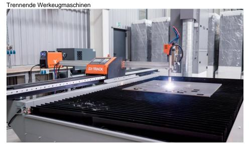
Das mobile CNC-Autogen-/Plasnma-Schneidsystem wurde für Einzelstücke und kleine Serien konzipiert (Bild: Thermacut).
