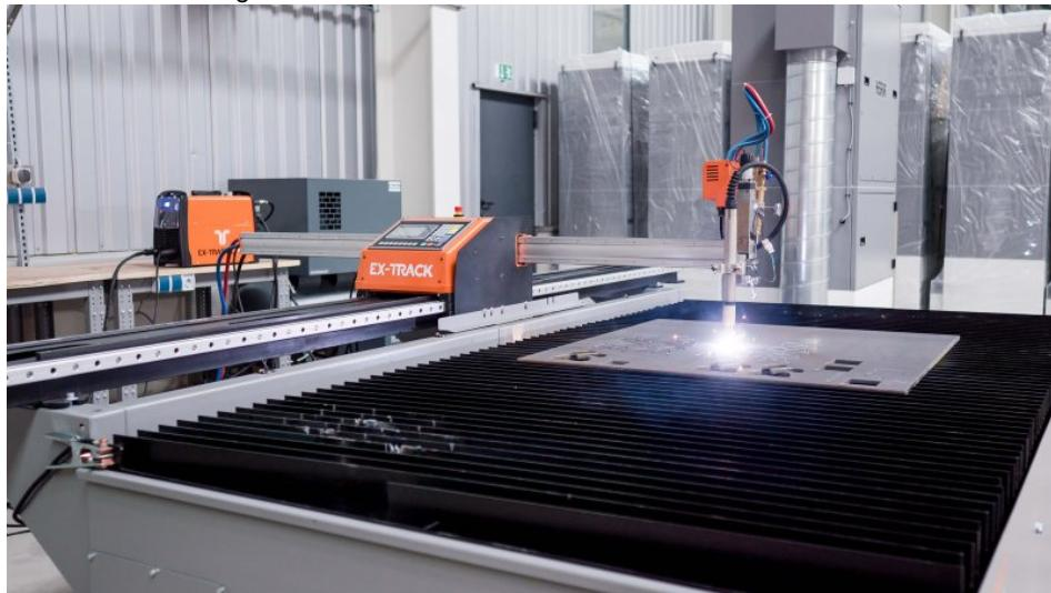
Das mobile CNC-Autogen-/Plasma-Schneidsystem wurde für Einzelstücke und kleine Serien konzipiert (Bild: Thermacut).
