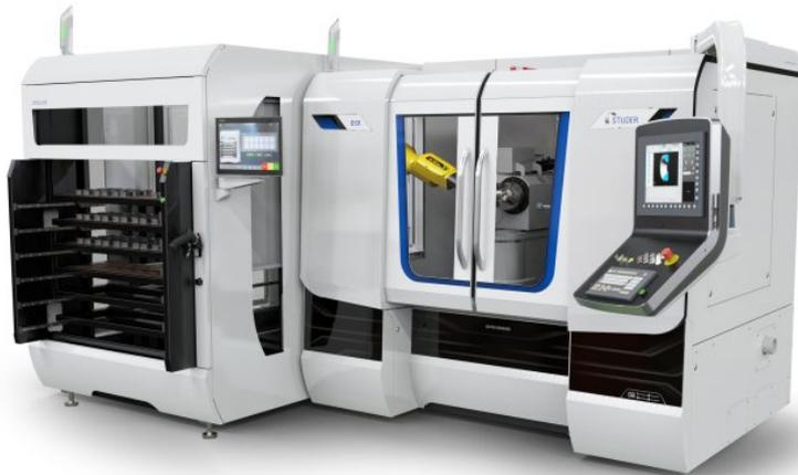
Beispiel einer Radien-Innenrundscheifmaschine mit dem neuen Roboter-Ladesystem (li.; Bild: Studer).
