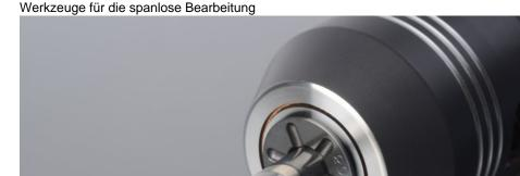
Das neue Werkzeug zur Oberflächenbearbeitung trägt dazu bei, den Polieraufwand zu reduzieren (Bild: Fraunhofer IPT).
