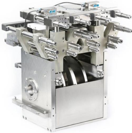
Eine hochkomplexe Baugruppe sorgt z. B. dafür, dass Infusionsbeutel sicher gegriffen, geöffnet und befüllt werden (Bild: Wassermann).
