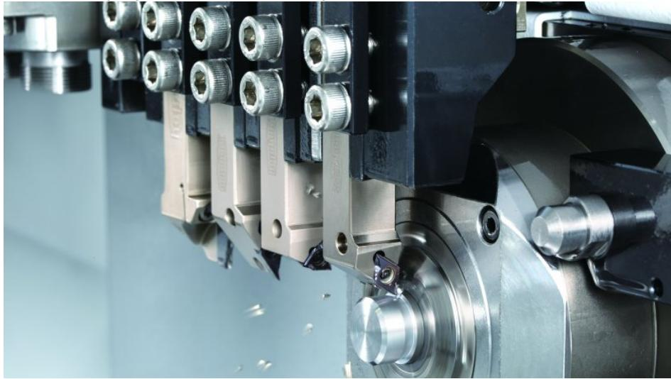
Die negative Wendeschneidplatte kann jetzt auch für die Miniaturbearbeitung eingesetzt werden (Bild: Tungaloy).
