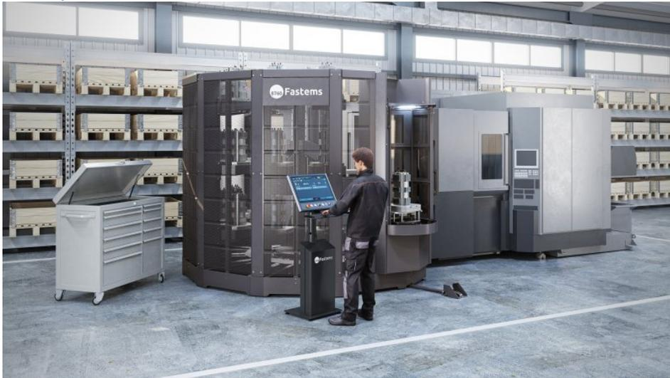
Die besonders kompakte und flexible Automationslösung verbessert die Effizienz von CNC-Fräsmaschinen (Bild: Fastems).
