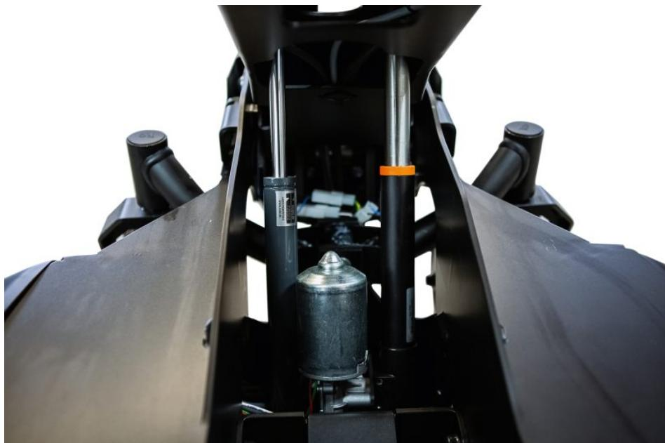
Die integrierte Industrie-Gasdruckfeder (li.) unterstützt die Hubkraft des elektrischen Liftmotors im neuen Pflege- und Stehrollstuhl (Bild: Paravan)
