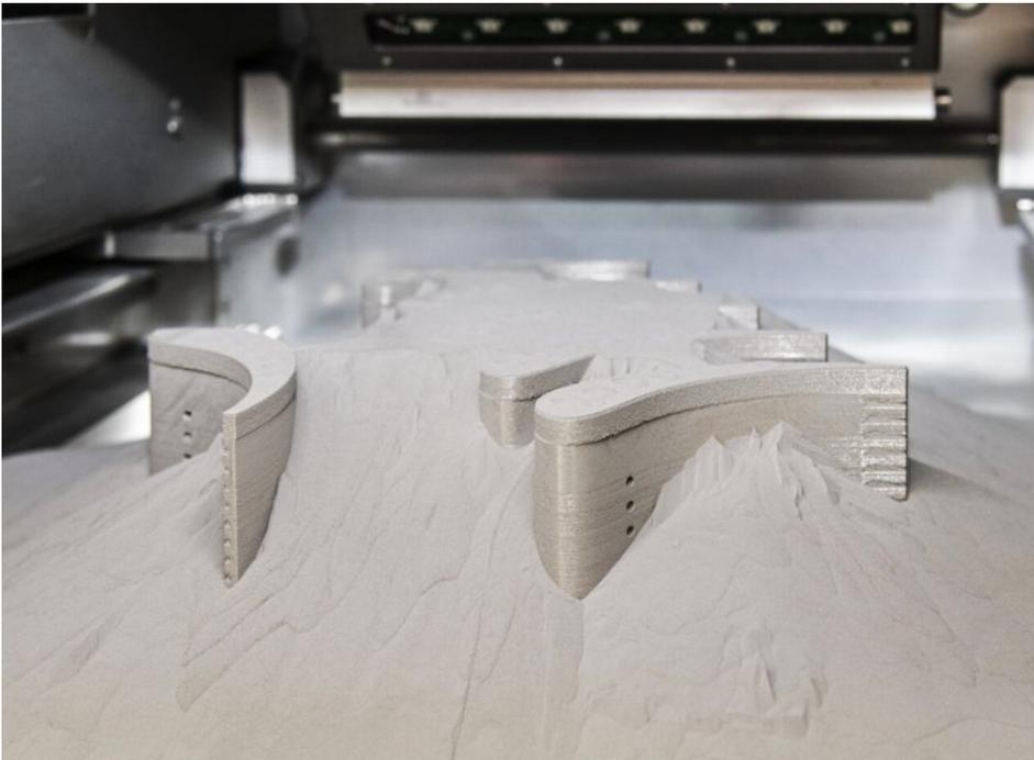
Anwendungsbeispiel additive Fertigung von Turbinenschaufeln (Bild: BAM).
