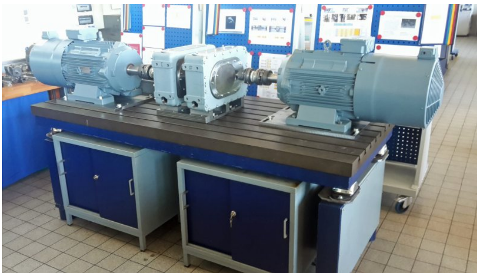
Prüfstand für Zahnräder zur Ermittlung von Dauerfestigkeitskurven (Bild: Hochschule Aalen).
