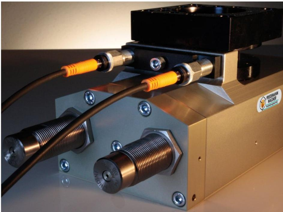
Sensoren, Anschlagsschrauben und Dämpfer zeigen in eine Richtung, wodurch die Justierung erleichtert wird (Bild: Friedemann Wagner).
