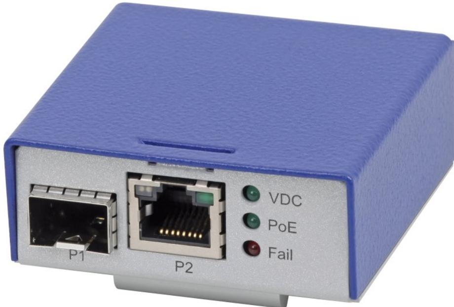
Die kompakten Medienkonverter erreichen Übertragungsentfernungen von bis zu 20 km (Bild: EKS Engel).
