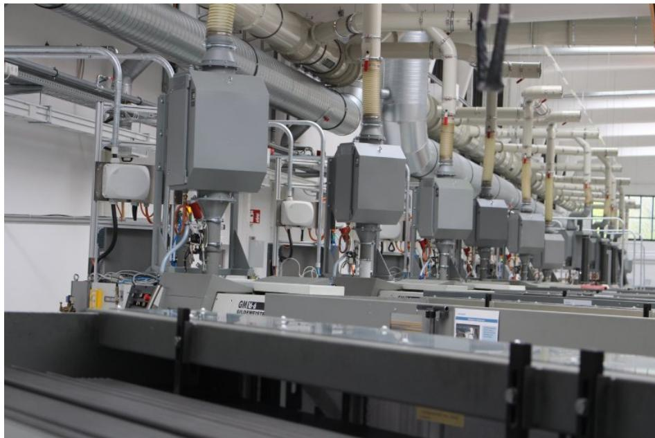
Zwischen Werkzeugmaschine und Absaugleitung installiert, lässt die Flammensperre zwar die abgesaugte Luft ungehindert hindurch, eine Flamme oder Verpuffung hält sie dagegen effektiv und zuverlässig zurück und schützt so die Anlage vor Schäden durch Brand (Bild: Büchel).
