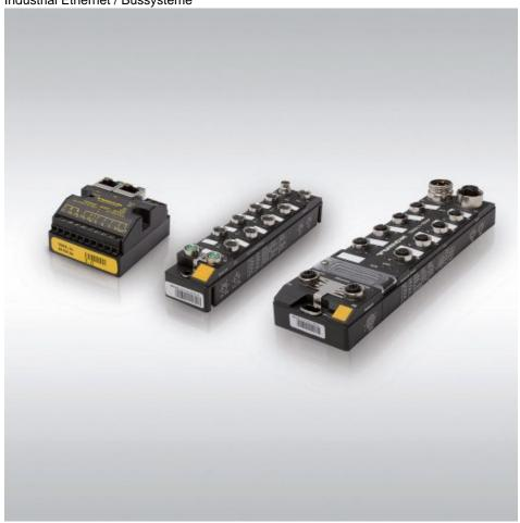
Mit dem »Backplane Ethernet Extension Protocol«, kurz »Beep«, vereinfacht Turck die Anwendung seiner Multiprotokoll-Block-I/O-Module »TBEN« und »FEN20«. Das Protokoll ermöglicht es, Netzwerke mit bis zu 33 TBEN-Modulen (1 Master, 32 Slaves) und bis zu 480 Byte Daten über eine einzige IP-Adresse in Profinet-, Ethernet/IP- und Modbus-TCP-Netzen an die SPS anzubinden. Durch die Reduzierung der IP-Adressen
