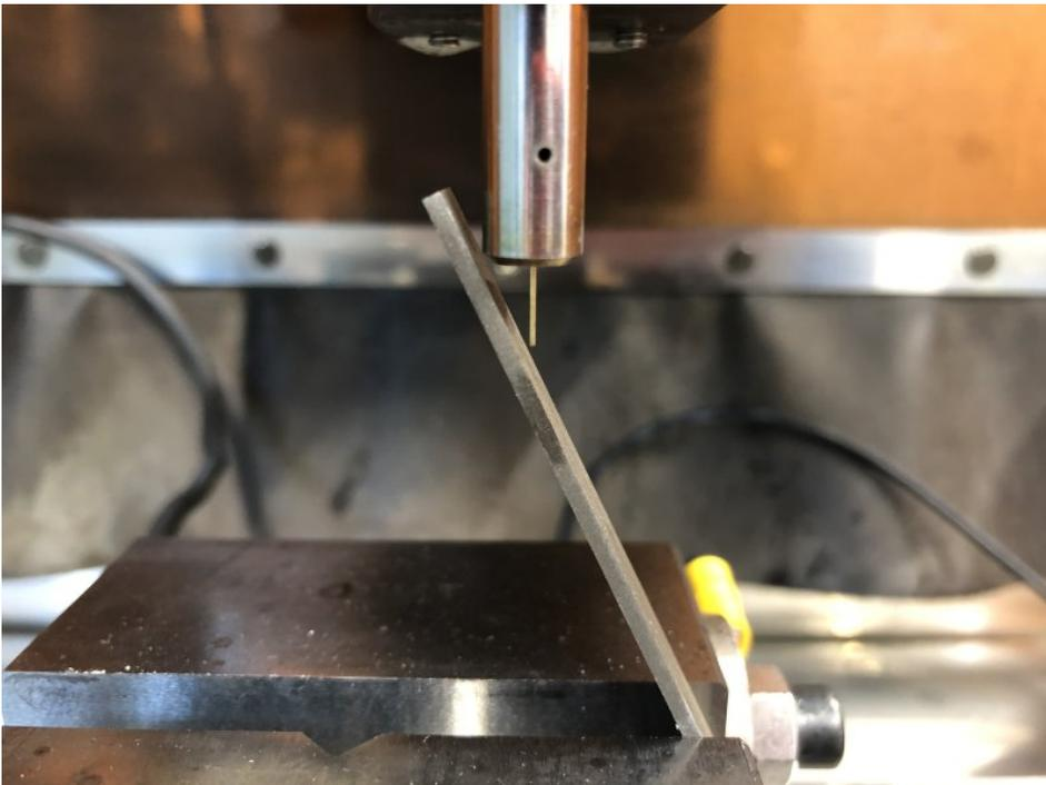
Das neue Dielektrikum verringert den Elektrodenverschleiß um bis zu 60 % (Bild: oelheld).
