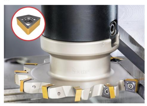
Mit den neuen Schlitzfräsern können Anwender jetzt auch schmalere Nuten mit Nutbreiten zwischen 10 und 14 mm einbringen (Bild: Iscar).
