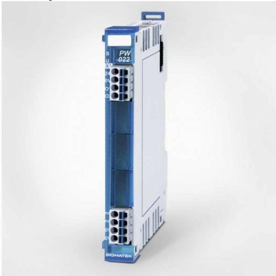
Das Pulsweitenmodul »PW 022« aus der »S-Dias«-Produktfamilie dient der Ansteuerung von induktiven und ohmschen Lasten. Mit dem kompakten Pulsweitenmodul können beispielsweise Magnet- und Proportionalventile komfortabel und präzise gesteuert werden. Das Modul verfügt über zwei +24V-schaltende PWM-Ausgänge, die für bis zu 1,5 A pro Kanal ausgelegt sind. Die PWM-Grundfrequenz
