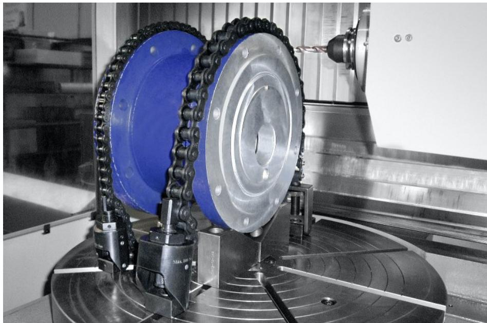
Die Kettenspanner ermöglichen ein sicheres Spannen von Werkstücken mit komplexen Formen (Bild: Kipp).
