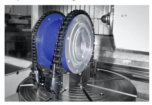
Die Kettenspanner ermöglichen ein sicheres Spannen von Werkstücken mit komplexen Formen (Bild: Kipp).
