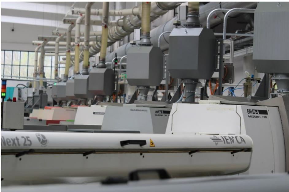
Auf einen verbesserten Brandschutz mit der Flammensperre von Büchel setzt z. B. die Wilhelm Böllhoff GmbH & Co. KG, die die komplette Fertigung damit ausrüsten ließ (Bild: Böllhoff).
