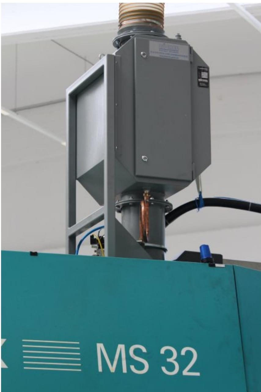
Die Sachverständigen vom Prüf- und Zertifizierungssystem der Deutschen Gesetzlichen Unfallversicherung (DGUV) bestätigen mit dem DGUV Test-Zeichen: Die Flammensperre von Büchel hält erfolgreich und zuverlässig Brände und Verpuffungen aus der Absauganlage fern (Bild: Böllhoff).
