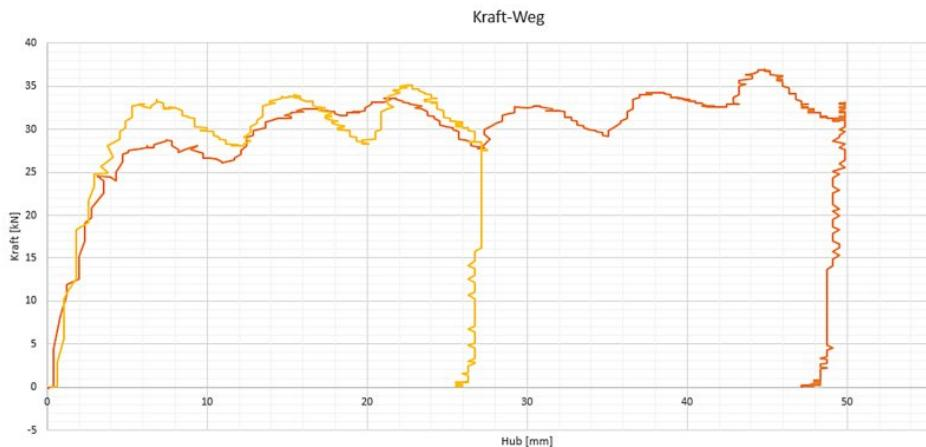
Hohe Energieaufnahmen sowie geringe Stützkräfte bei langem Hub, hier veranschaulicht anhand ihres Dämpfungsverhaltens bei maximaler und bei halber Hubnutzung (Grafik: ACE).
