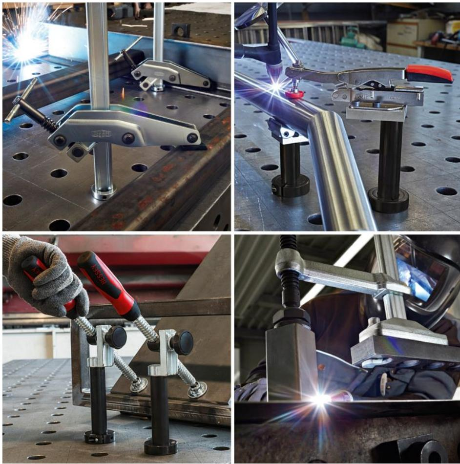
Selbst schräges und waagerechtes Spannen ist möglich (Bild: Bessey).
