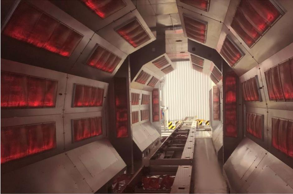
Die Produkte werden pulverbeschichtet und dann durch gaskatalytische Infrarotöfen befördert, um das Pulver anzugelieren (Bild: Heraeus Noblelight).
