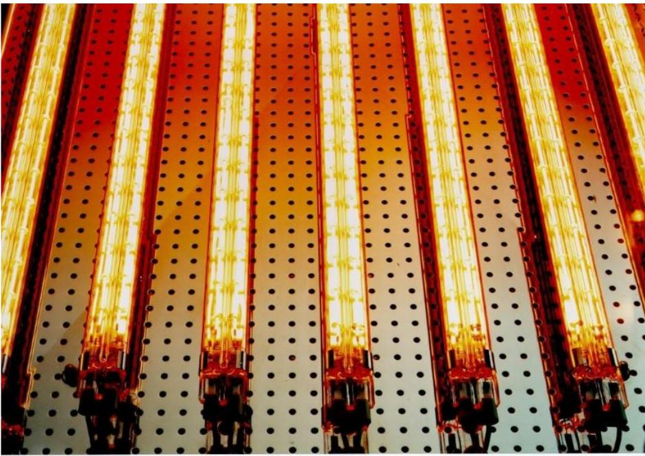
Die »Infrarot-Booster« wurden in einem Aluminiumrahmen mit Edelstahlreflektoren befestigt (Bild: Heraeus Noblelight).
