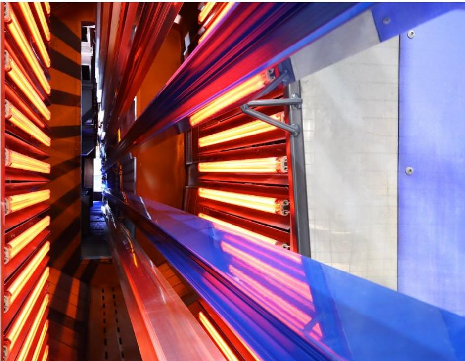
Infrarotwärme schmilzt Pulver schnell an und hilft so, Pulverschleppung zu vermeiden (Bild: Heraeus Noblelight).
