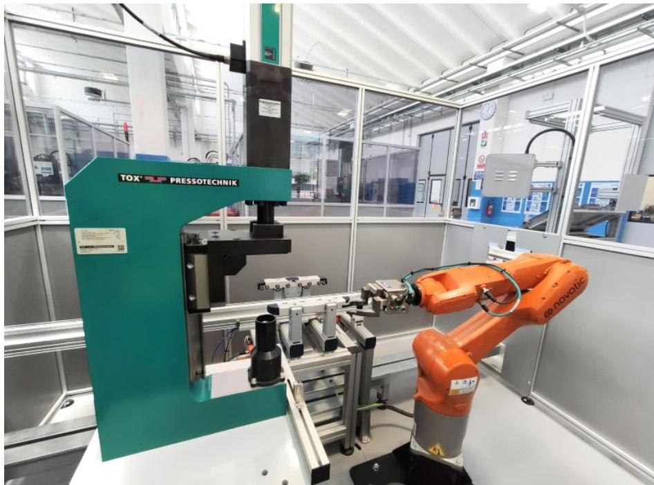
Systemintegrator Novotic installierte sechs Pressstationen für eine Montageanlage von Getriebebaugruppen (Bild: Tox Pressotechnik).
