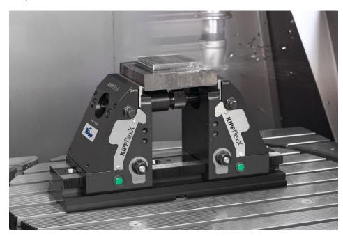
Der neue 5-Achs-Spanner eignet sich gleichermaßen für die Rohteilspannung und die Niederzugspannung (Bild: Kipp).
