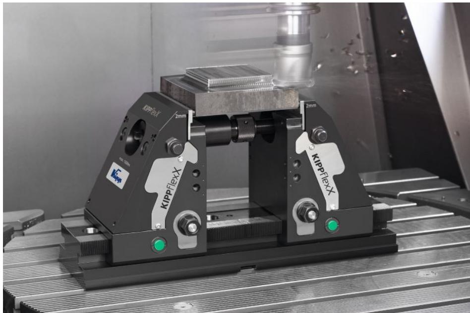
Der neue 5-Achs-Spanner eignet sich gleichermaßen für die Rohteilspannung und die Niederzugsspannung (Bild: Kipp).
