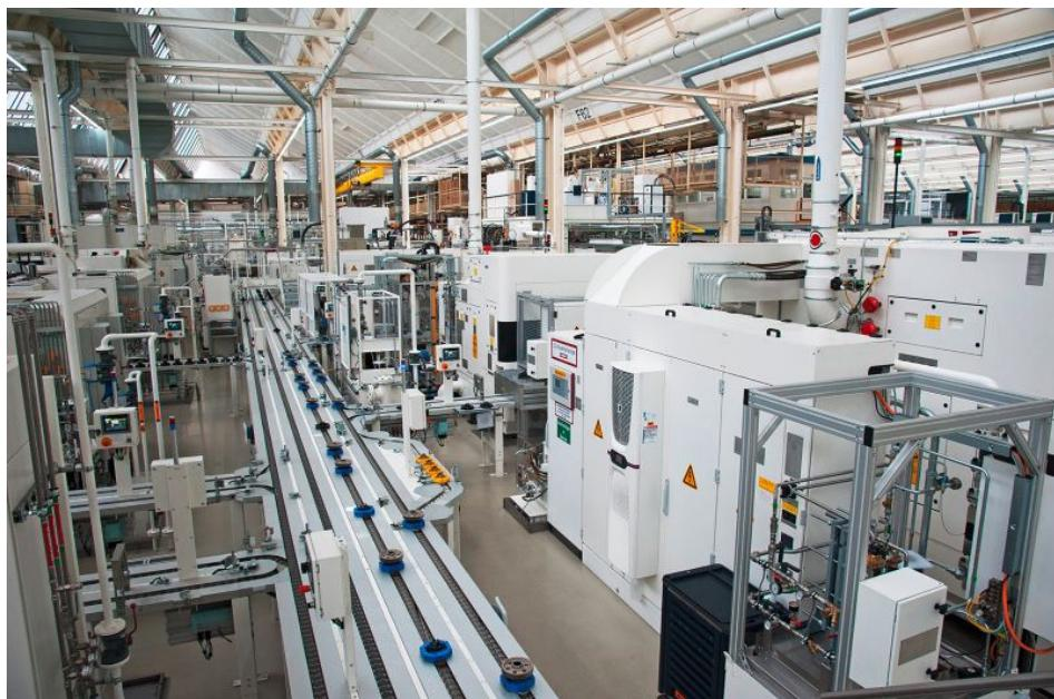
Für 880 Getriebe pro Tag werden Zahnräder im 34-Sekundentakt produziert (Bild: Martin Witzsch).
