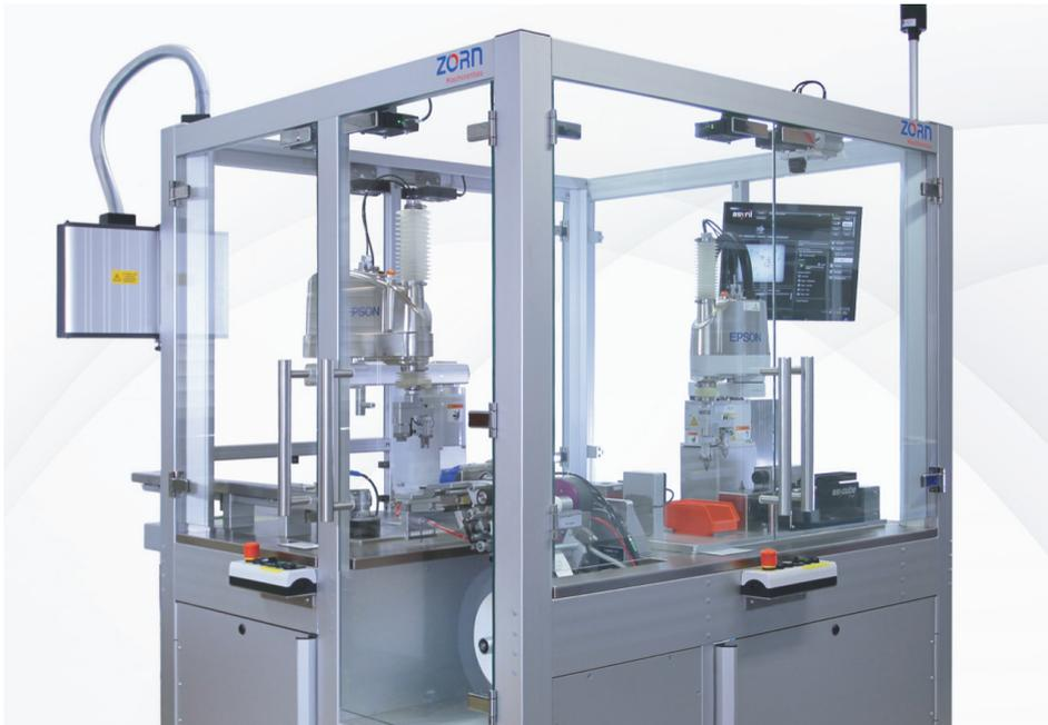
PI Reinraumoptimierte Linearachsen.jpeg Bestückt mit reinraumoptimierten Linearachsen hat das Miniatur-Bearbeitungszentrum auch staubempfindliche Fertigungsabläufe sicher im Griff (Bild: Zorn Maschinenbau).
