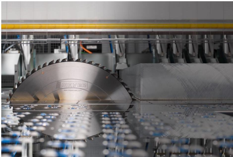
Speziell für die Zerspanung von NE-Metallen können die Sägen zum Beispiel mit einer Minimalmengenschmierung-Sprühseinrichtung ausgestattet werden (Bild: Felder Group).
