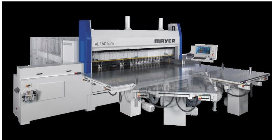
Die Plattenaufteilsäge »AL 160 turn« bietet komfortable Bedienbarkeit für einfaches Materialhandling ohne zusätzliche Hebemittel (Bild: Felder Group).
