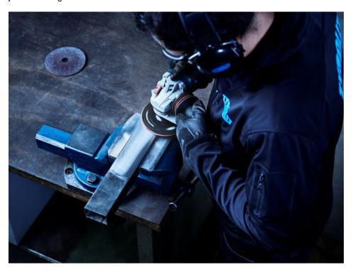
Verpresste Scheiben haben meist einen Durchmesser von weniger als 150 Millimeter und eignen sich daher besonders für die Verwendung auf portablen Maschinen (Bild: Tyrolit).
