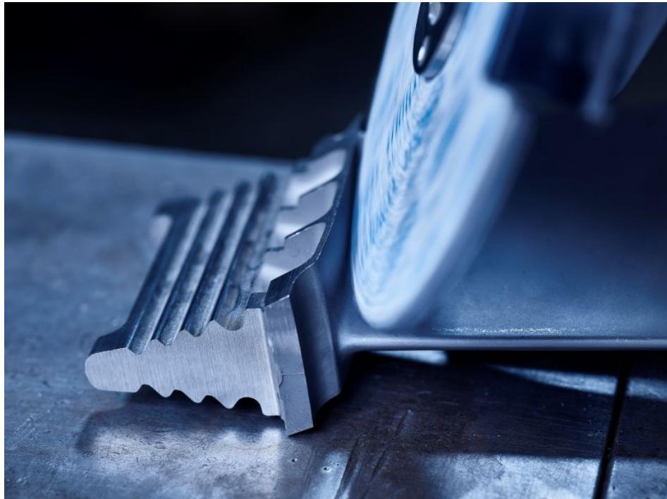
Schleifvliese werden unter anderem für das einfache Entgraten ohne Deformierung des Werkstücks, zur Reduzierung der Rautiefe und zur Entfernung von Farbrückständen eingesetzt (Bild: Tyrolit).
