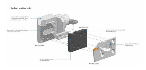
Aufbau des modularen Stechsystems (Bild: ZCC).
