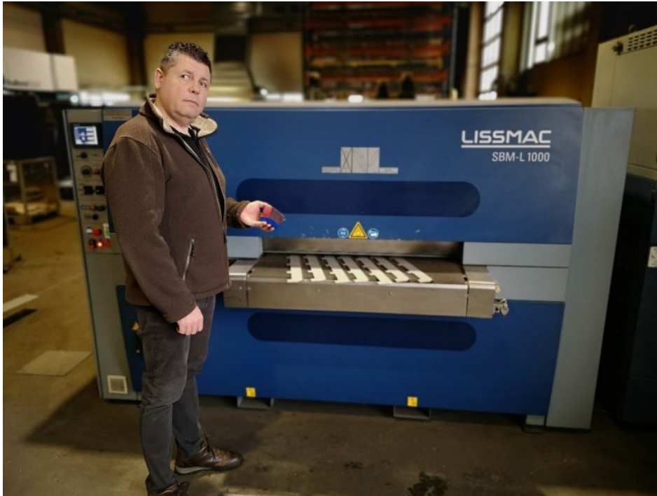
Uwe Mader an der Entgratmaschine, die mit den neuen Schleifblöcken ausgerüstet wurde (Bild: Picard).
