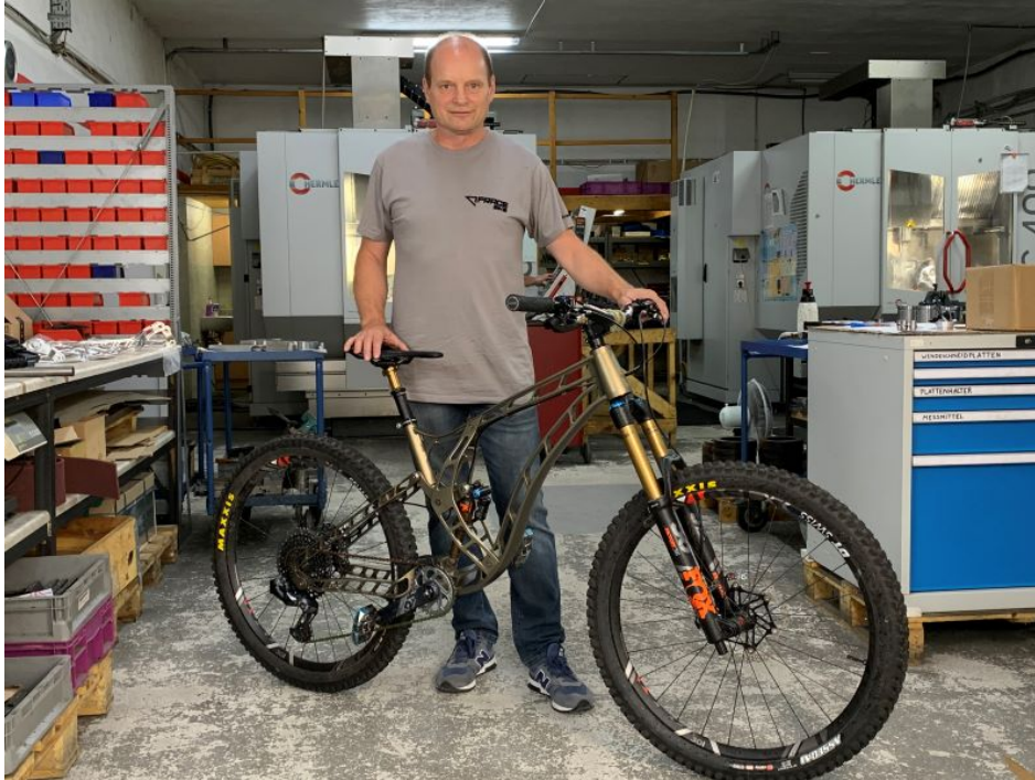
Bernd Iwanow und sein »Frace F160«, dem aus dem Vollen gefräste Aluminium-Bike (Bild: Ceratizit).
