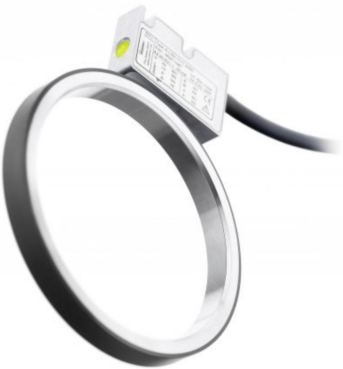
Ein Trend, der gerade in der Aufzugstechnik zunimmt, ist der von lagerlosen Drehgebern bzw. berührungslosen magnetischen Messsystemen. Das lagerlose Messsystem ist vor allem für Außenläufermotoren besonders geeignet. Kübler, als Spezialist für Positions- und Bewegungssensorik, bietet genau solche Messsysteme an, die aus einem inkrementalen Sensor und einem Magnetring bestehen. Die Vorteile dieses
