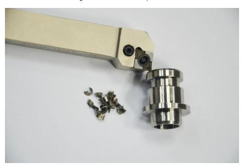
Bei der Bearbeitung entstehen Späne, die sich problemlos abführen lassen und so für unterbrechungsfreie Prozesse sorgen (Bild: Iscar).
