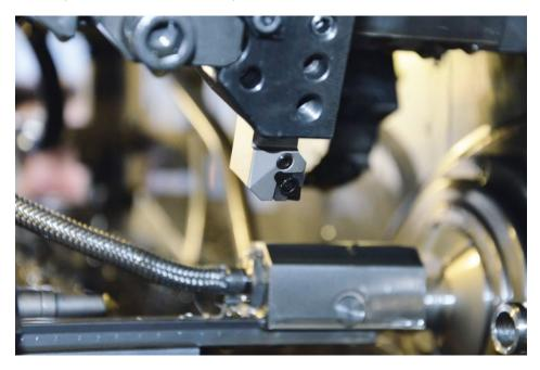
Durch den Einsatz der positiven-doppelseitigen Wendeschneidplatten haben sich die Standzeiten bei Schauerte im Vergleich zur früheren Lösung verdoppelt. (Bild: Iscar).
